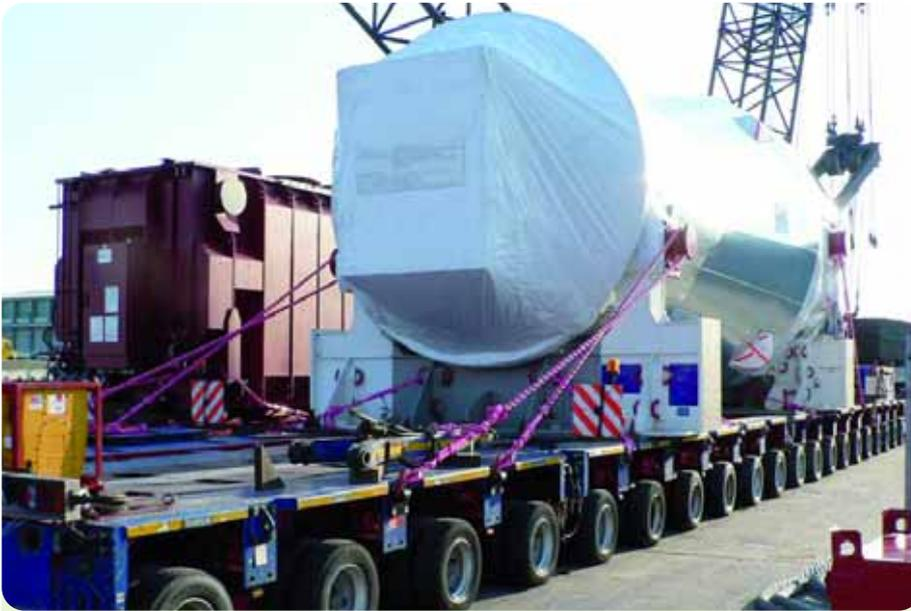
**Fachkenntnis:** Durch Anschlag einer Zurrkette an einer Turbine im „Doppel-U“ wurde die Lashing Capacity von 20.000 auf 40.000 daN erhöht.
