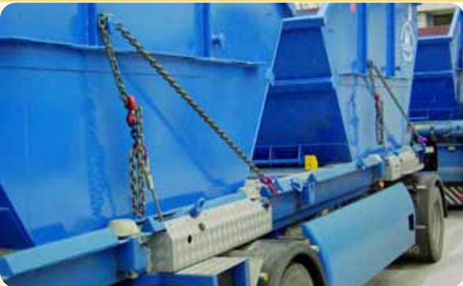
**Funktionelle Ladungssicherung:** Eine Besonderheit ist die Verspannung der Absetzmulden.
