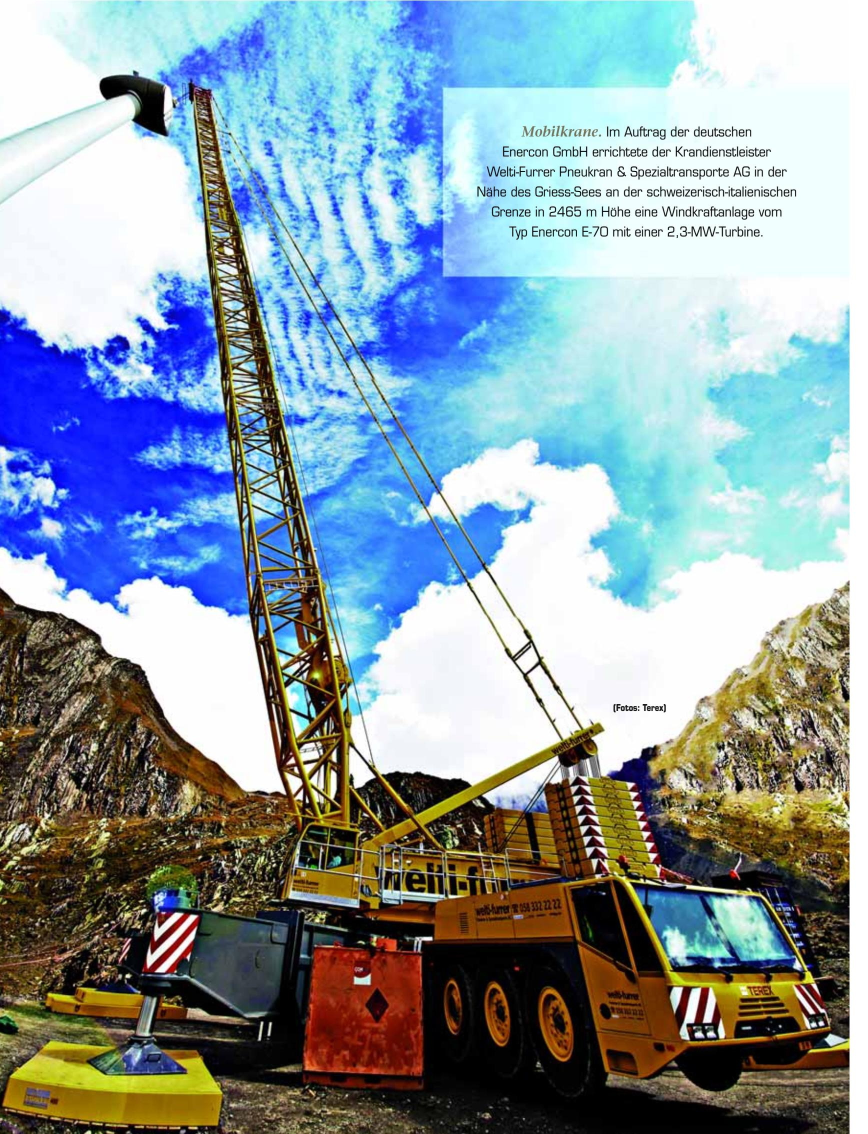
*Mobilkrane.* Im Auftrag der deutschen Enercon GmbH errichtete der Krandienstleister Wälti-Furrer Pneukran & Spezialtransporte AG in der Nähe des Griess-Sees an der schweizerisch-italienischen Grenze in 2465 m Höhe eine Windkraftanlage vom Typ Enercon E-70 mit einer 2,3-MW-Turbine.
