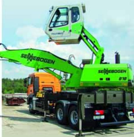
Für das Handling von Schrott beschaffte KOVOD einen MAN mit einem Sennebogen 818. (Foto: Sennebogen)
