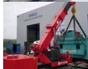
*Mobilkran Kapazität 68 to. und Lift System Model 48 A bei einer Pressenmontage*
