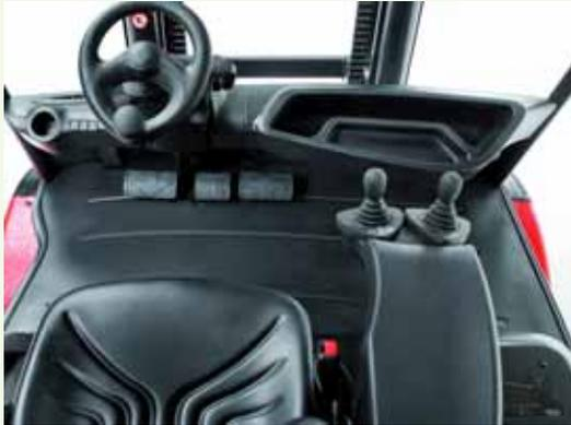
◀ **Fingerleichter Hub:** Für mehr Bedienkomfort sorgt die Linde-Load-Control zur Steuerung der Mastfunktionen.
