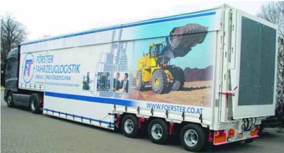
**Klar zum Aufsatteln:** Der neue Sattelanhänger von Eggers ist speziell für den Transport von Staplern konzipiert.
