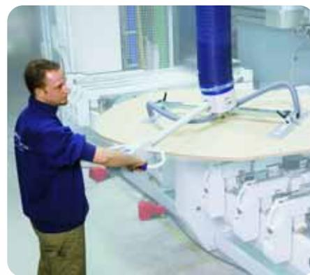
**Erhebende Saugkraft:** Der Vakuum-Schlauchheber JumboErgo bringt eine rund 50 kg schwere, beschichtete Spanplatte zur CNC-Bearbeitungsmaschine.
