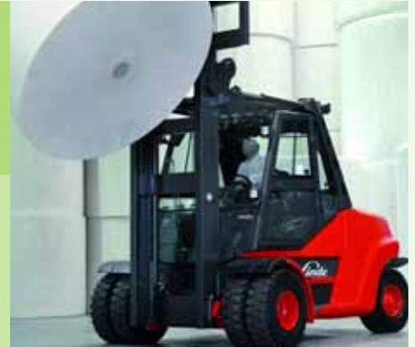
feld. Weiterer Punkt des Hubmastkonzepts ist die Linde-Torsionsstütze zusammen mit dem Torsionsgitter. Die Komponenten verbinden den Hubmast mit dem Gegengewicht und stabilisieren ihn gegen seitliche Verdrehungen. So wird selbst in hohen Hubhöhen oder bei pendelnden Lasten eine deutlich größere Verwindungssteifigkeit des Hubmastes und damit in der Praxis ein sichereres Lasthandling erreicht.
