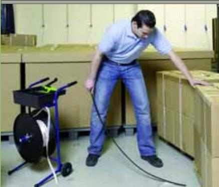
**Geschickt eingefädelt:** Die Palettiermadel erleichtert das Anbringen der EasyLash-Spannbänder bei der Palettensicherung.
