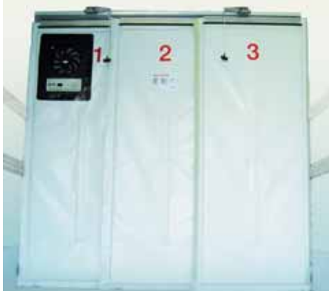
Jetzt auch für Multi-Temperatur-Transporte: Das Kälterückhaltesystem Cool Slide® II von Kiesling. (Foto: Kiesling)
