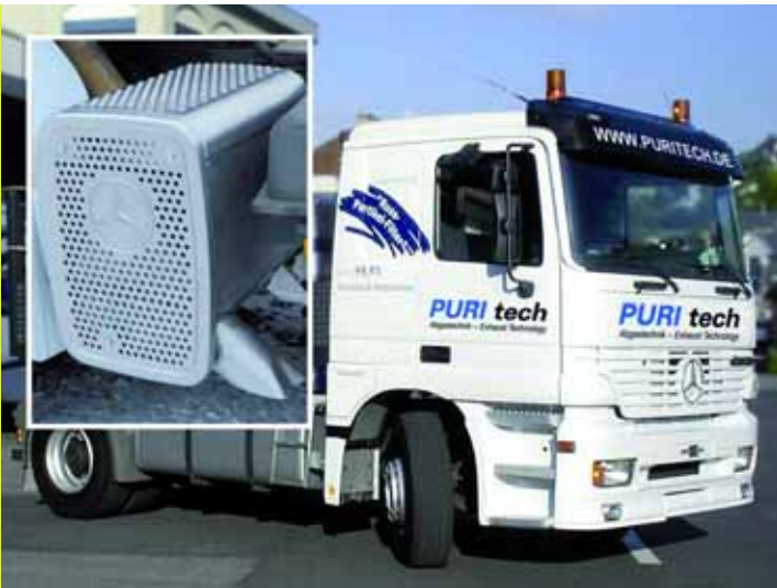
NACHRÜSTUNG IM GROSSMASS-STAB: Über einen Rahmenvertrag erhalten die Mercedes-Benz-Lkw-Baumuster mit Euro-3-Norm Partikelfilter von PURI tech.
