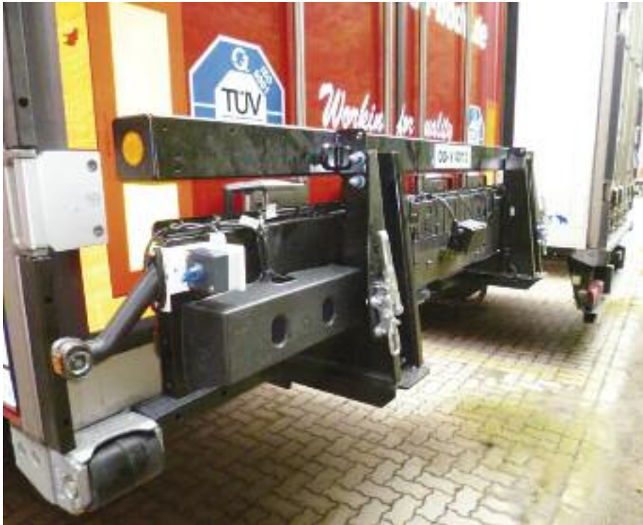
Hochgeklappt sichert der heckseitige Unterfahrerschutz das Heckportal vor Rempelen beim Handling. (Fotos: Spedition Bode, sk)
