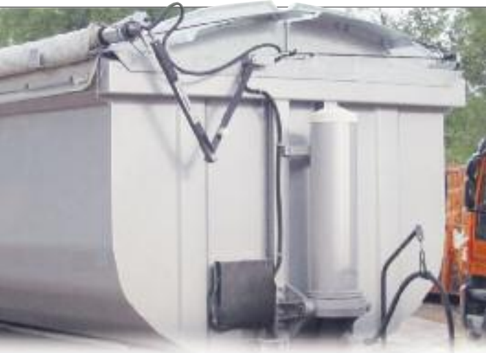
Keine störenden Planenpakete: das elektrische Seitenrollverdeck Revoplan. (Foto: AIRpipe)
