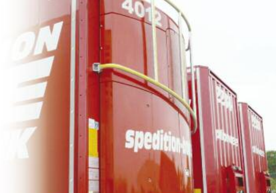
Nachgerüstete Schutzmaßnahmen: Um Anfahrtschäden zu minimieren werden neuralgische Punkte wie das Kühlaggregat besonders geschützt.
