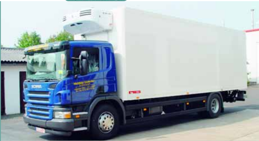
Optimal isoliert: Der Kofferaufbau COOLONE hat in der Grundausführung einen K-Wert = < 3,38 W/m 2 K.
