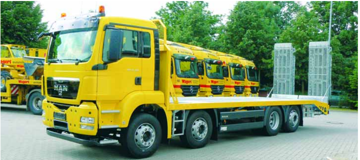
Hang zu Vier-Achsern: Die größeren Transporter verfügen nicht nur über eine höhere Nutzlast, sondern reduzieren auch die tatsächlichen Vorderachslasten.
