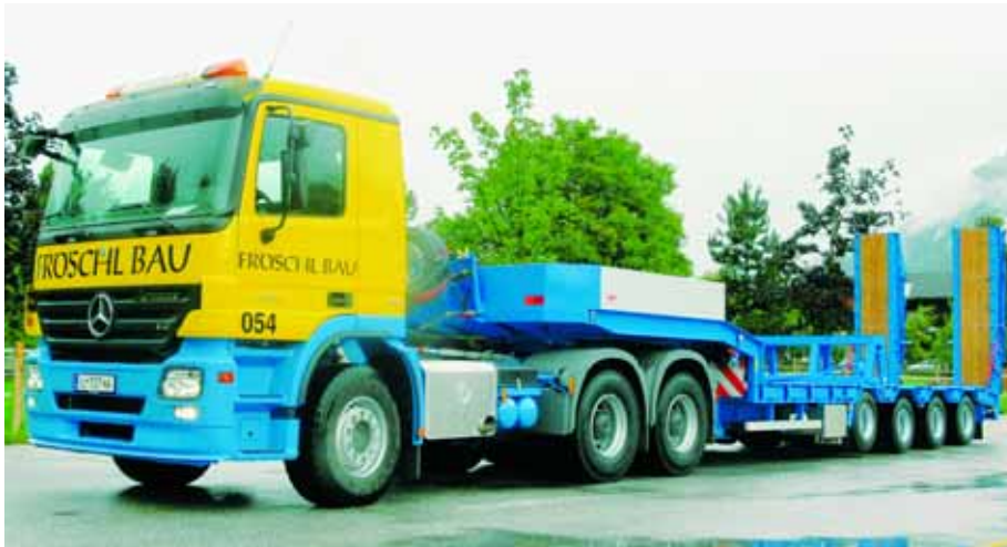
Eine von vielen Varianten: Für den alternativen Transport von Langgut verfügt der vierachsige Tieflade-Trailer von Empl über einen entsprechenden Auflagebock.
