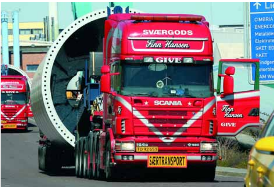
ALLES IST MÖGLICH: Die Scania-Tochter Laxå Special Vehicles rüstet die Schwerlast- und Sonderfahrzeuge nach Kundenwunsch auf. Hier ein Scania R144 GA8x4/4 530 mit fünfter Achse.
