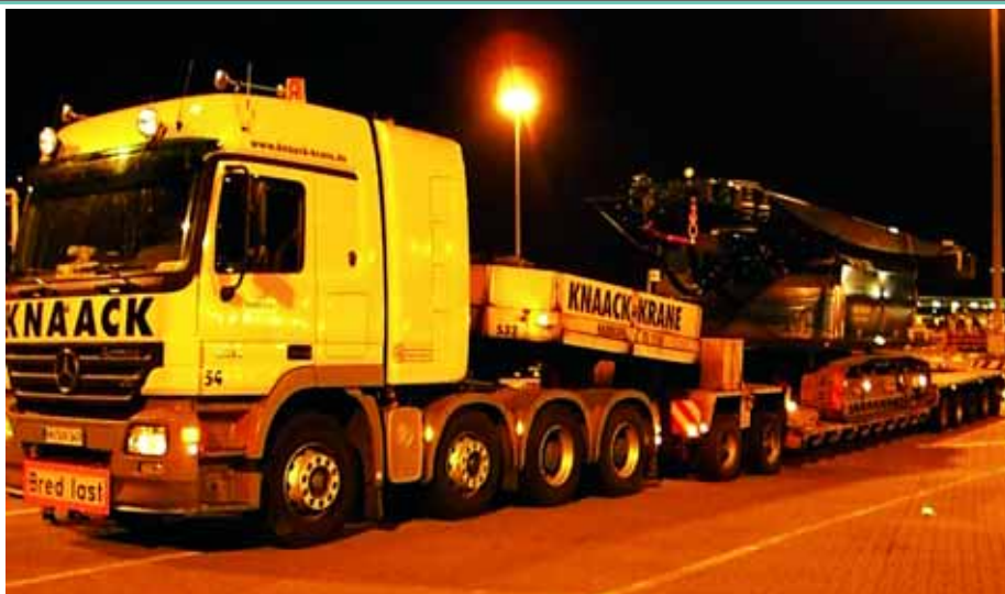
POWER MIT STERN: Der Actros SLT ist für Gesamtzuggewichte bis 250 t ausgelegt. Zur IAA wird eine neue Generation vorgestellt.
