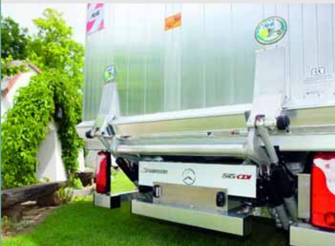
Leichte Ladehilfe: AHT setzt bei seinen Ladebordwänden auf Vollaluminium.
