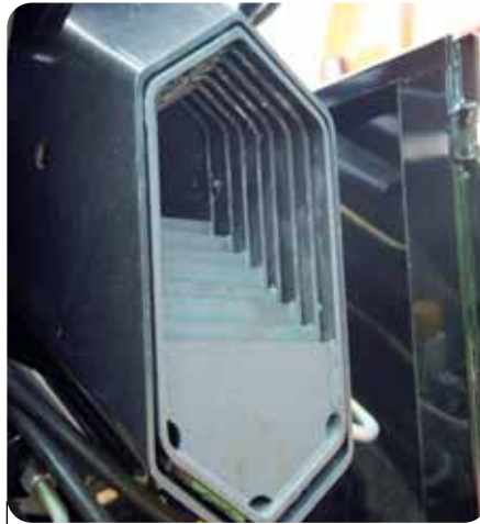
Neues Profil für Hannover: Die Ausschubelemente des neuen Terex TLC 380.3 haben ein neu entwickeltes Sechskantprofil für verbesserte Leistungswerte.
