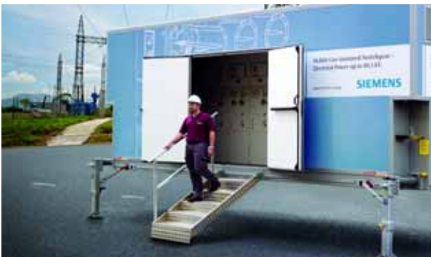
Mobile Schaltanlage: Auch dieser für Siemens gefertigte Wechselbehälter von Göbel & Sohn Fahrzeugbau zeigt die Vielfalt dieses Konzeptes.
