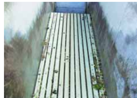
Auf der Entsorga vorgestellt: Schubbodentechnik von Cargo Floor mit stählernen Profilen.
