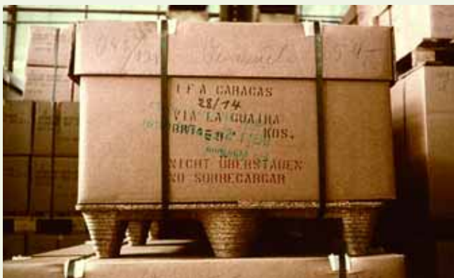
EINWEG-EXPORT: Prozessholzpaletten sind aufgrund des Herstellungsverfahrens nicht von der Markierungspflicht nach ISPM 15 betroffen.
