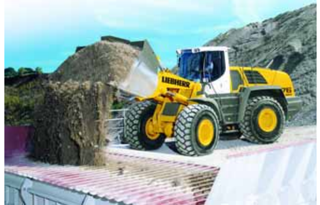
LIEBHERR-MOTOR D936L, TEIL 3: Im L 576 2plus2 kommt der Antrieb in einer 200-kW-Variante zum Einsatz.
