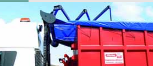
Abdecken per Fernsteuerung: Das neue Multilift-Easycover.
