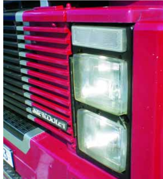
Rechteckig und zeitgemäß: frühe AE-Scheinwerfer. (Fotos: Renault Trucks, fh)
