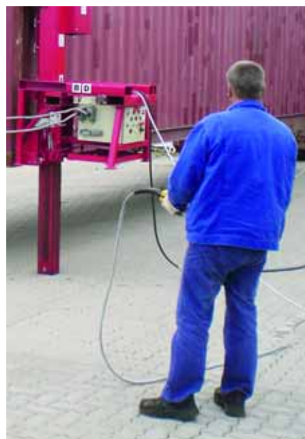
▲ AUFNEHMEN ODER ABLEGEN: Die Bedienung der Hubeinrichtung erfolgt über eine kabelgebundene Fernsteuerung, die mit der zentralen Steuereinheit verbunden ist.
