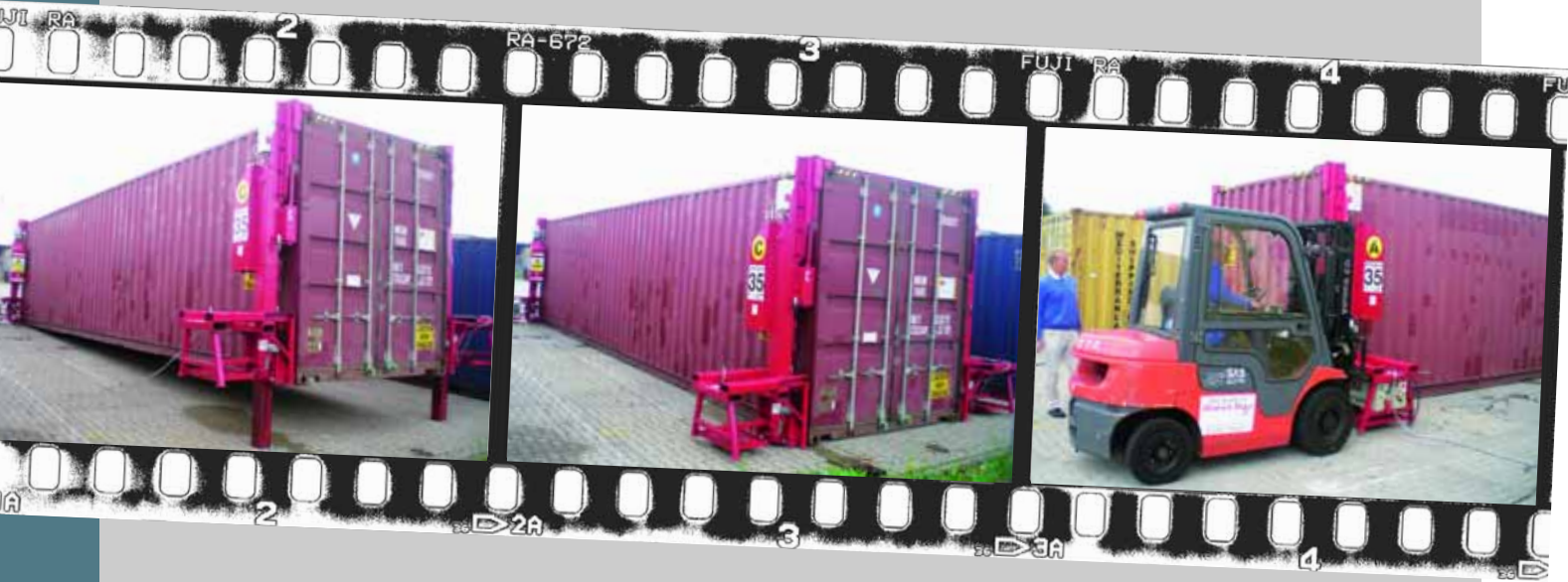
▲ EBENERDIGES ABSETZEN: Nach dem Ausfahren des Fahrgestells kann der Container auf die gewünschte Be- oder Entladehöhe gebracht oder zu Reinigungszwecken auch leicht schräg abgesetzt werden.
