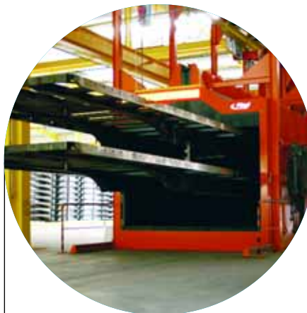
Enter Sandman: Die Rahmen werden paarweise gesandstrahlt.
