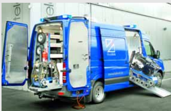
Für gefährliche Einsätze: Ein telerob-Einsatzfahrzeug vom Typ TEL 620 auf der Basis eines Mercedes-Benz Sprinter.
