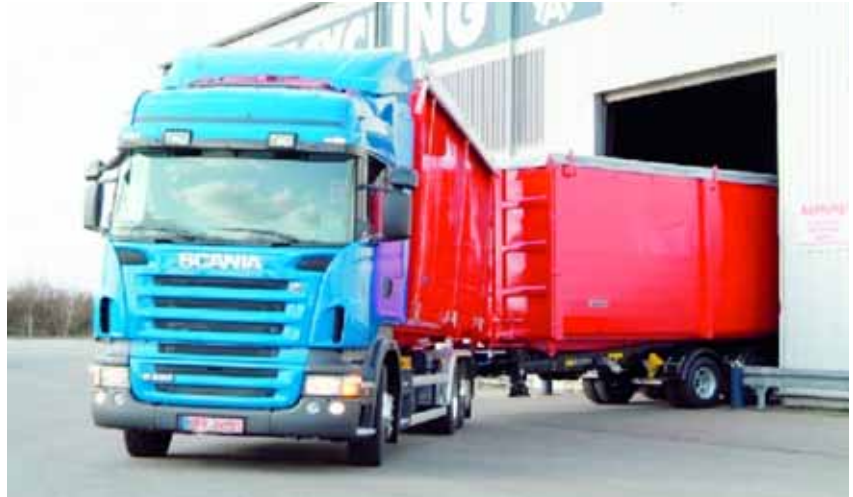
Maximales Volumen: Der Volumax von Hüffermann ist eine Abrollbehälter-Fahrzeugkombination mit Zentralachsanhänger.
