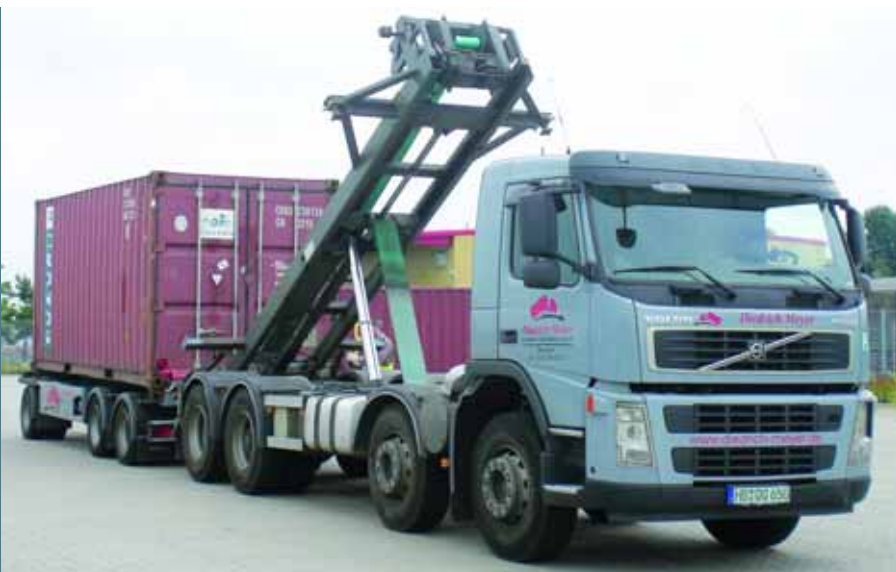
ERSTE WAHL: Der Volvo FM von Diedrich Meyer wird mit Liftsystem zum Umsetzen und Transportieren der Boxen eingesetzt.
