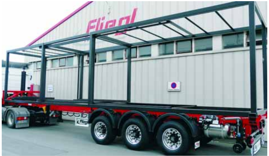
Variabilität ist Trumpf: Zur IAA präsentiert Fliegl ein dreiachsiges Kipp-Chassis für unterschiedliche Containerlängen.
