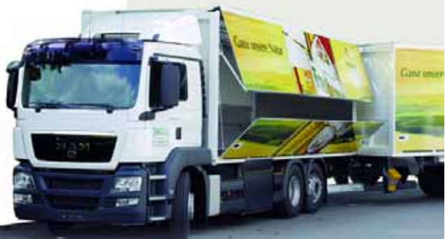
Aufbauzertifizierung nach VDI 2700 Blatt 12 und DIN EN 12642 Code XL für alle EWERS-Aufbauten von 3,5 bis 40 t GG. (Foto: Fahrzeugbau EWERS)
