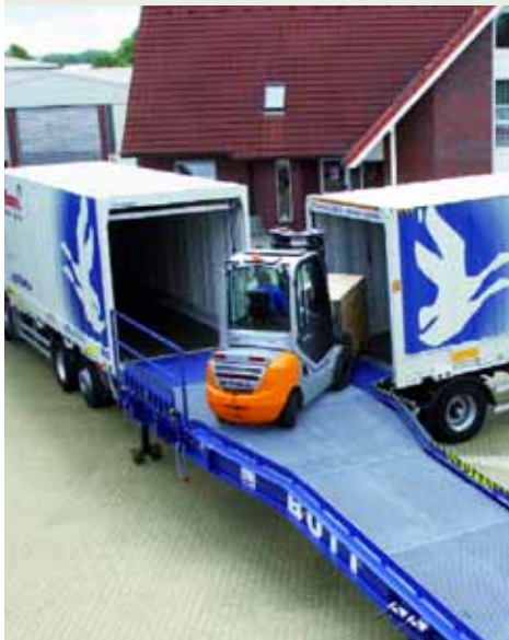
Durchdachte Lösung: Eine mobile Verladerampe von BUTT zur Drei-Seiten-Verladung. (Foto: Butt)
