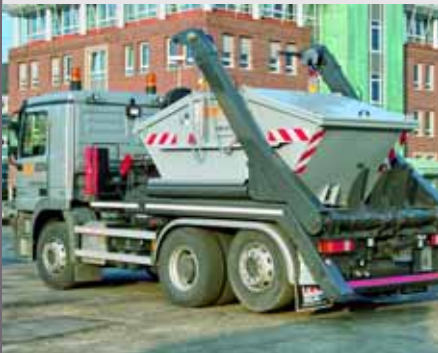
Dieser VDL-Absetzkipper hat zusätzlich eine Zwei-Klauen-Verriegelung für Spezialbehälter.
