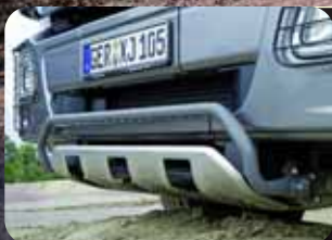
WIRKSAMER SCHUTZ: Von unten werden Motor und Kühler von einer 3 mm starken und hochfesten Edelstahlplatte geschützt.
