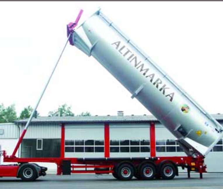
HOCHFLEXIBLE SILO-LÖSUNG: Silo-Container mit Kippchassis von Spitzer Silo-Fahrzeugwerke.
