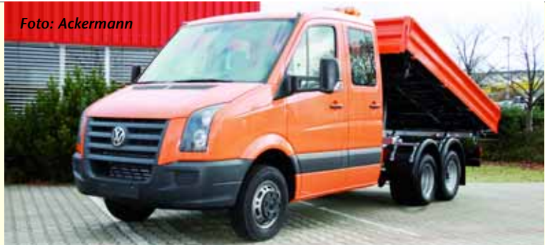
3,7 t Nutzlast: Ein Crafter 50 von Ackermann mit Doppelkabine, Drei-Seiten-Kipper und dritter Achse.
