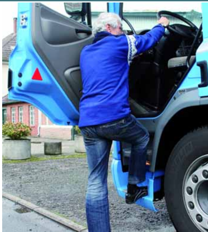
LEICHTER EINSTIEG: Die Stufen sind so bemessen, dass der Weg ins Fahrerhaus nicht zur Kletterpartie wird.
