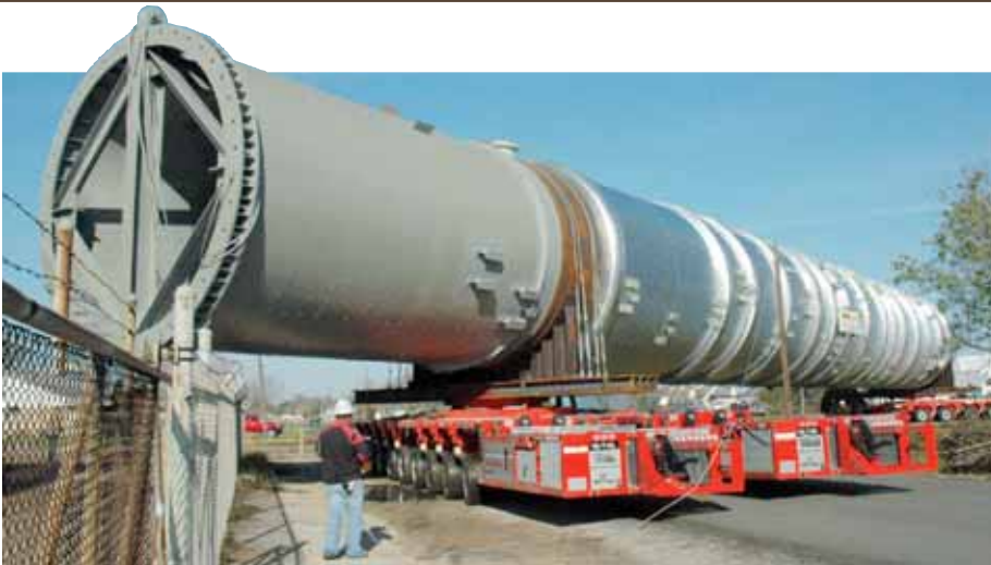
Beladung einer 16-achsigen P-Kombination: Für den Ausbau der bestehenden Flotte orderte das amerikanische Unternehmen Berard weitere 20 Achsen bei Goldhofer.
