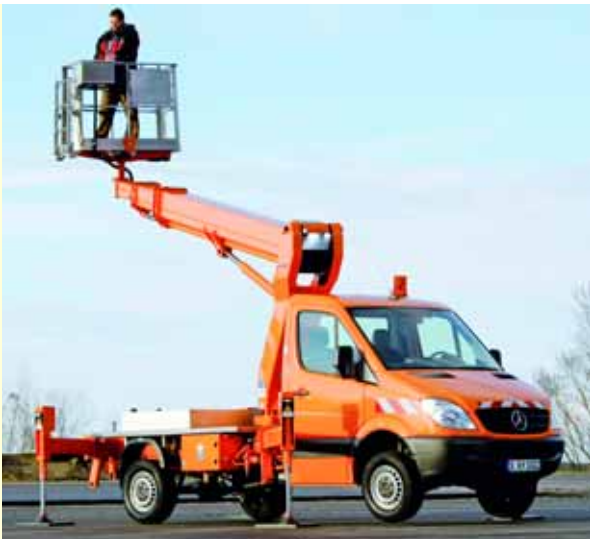
HOCH HINAUS: Der Sprinter stellt eine beliebte Basis für Hubarbeitsbühnen, wie hier von Ruthmann, dar.
