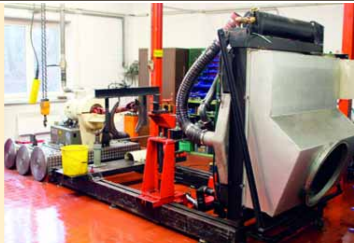
AUFWÄNDIGE PRÜFTECHNIK: Jedes instand gesetzte Aggregat wird auf dem Prüfstand auch einem Leistungstest unterzogen.
