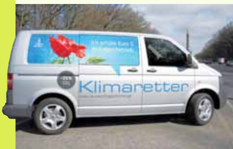
Unterschreitet Limit für Pkw-Euro-5: Volkswagen-Transporter mit Erdgasantrieb von IAV.
