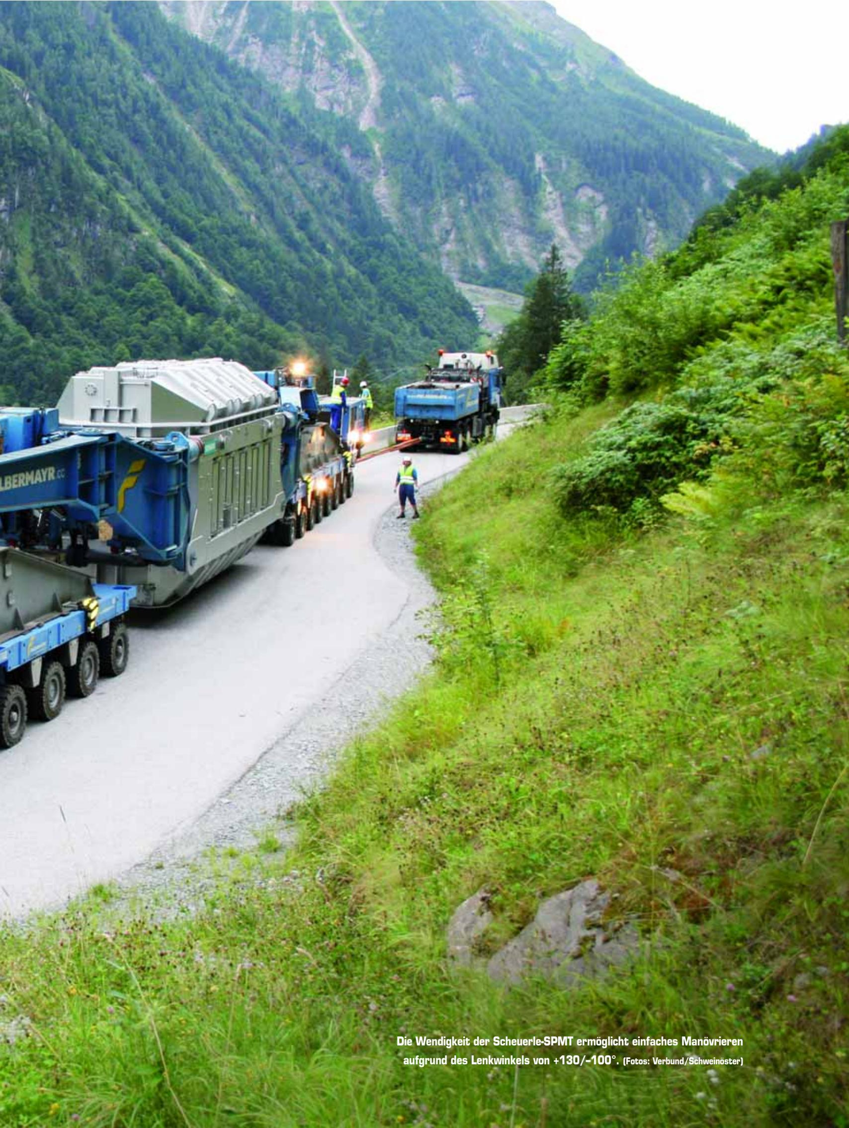
Die Wendigkeit der Scheuerle-SPMT ermöglicht einfaches Manövrieren aufgrund des Lenkwinkels von  $+130/-100^\circ$ . [Fotos: Verbund/Schweinöster]
