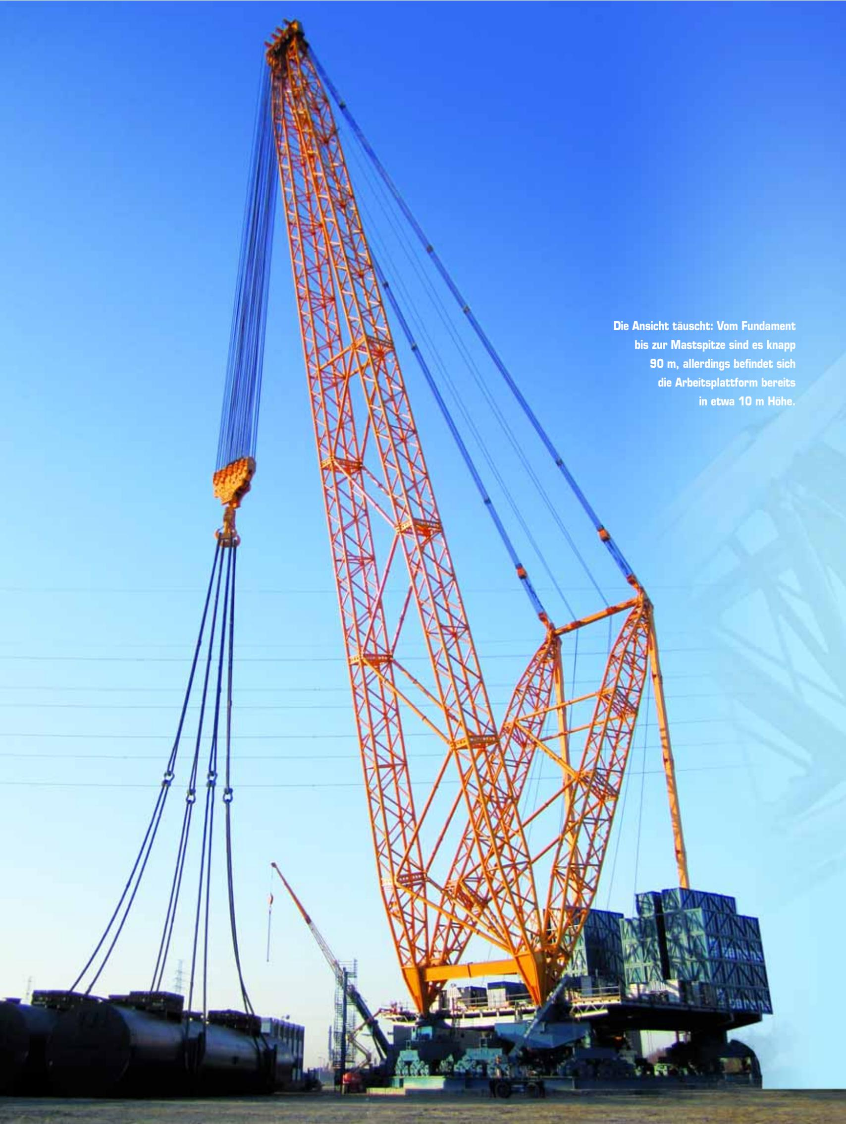
Die Ansicht täuscht: Vom Fundament bis zur Mastspitze sind es knapp 90 m, allerdings befindet sich die Arbeitsplattform bereits in etwa 10 m Höhe.
