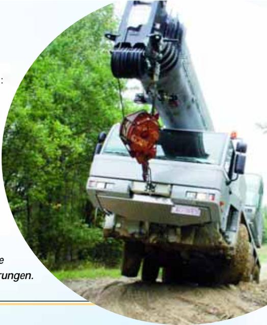
einen separaten 128 kW (174 PS) starken Mercedes-Benz-Motor. Aus der so genannten „Cockpit“-Oberwagenkabine ist ein komfortables Handling von Kran und Last gewährleistet, wie beispielsweise die Montage des mehrteiligen 22,3-t-Gegengewichtes oder auch das Verfahren des Krans und die Betätigung der vollen und halben Abstützung „von oben“.
