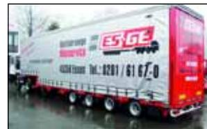
3-6-achsige Satteltiefflader in Niedrigbauweise mit Curtainsider-Aufbau, 800 mm Ladehöhe, anheb- und verbreiterbar aus ca. 4600 mm
