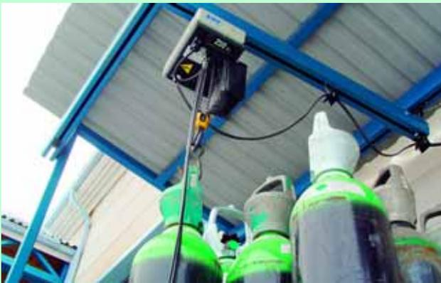
Sichere Arbeit im „Pulverfass“: Der Elektrokettenszug SK für den Einsatz in Zone 22.
