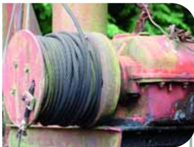
So bitte nicht: *Dieses Seil ist längst abgereift und darf auf keinen Fall mehr verwendet werden.*
