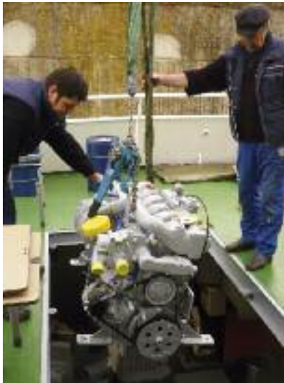
Spezialisten ersetzen die Verschleißteile und montieren die Motoren neu.
