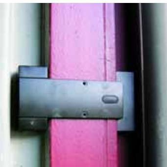
**Verfolgt: TSR-TEUcom ermöglicht die Wegverfolgung von Containern und überwacht Öffnungen und Streckenfenster.**
