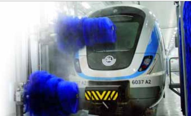
**Blitzsauber: Bis zu 107 m lange Zugeinheiten können innerhalb von 15 Minuten in der von Tammermatic gelieferten Waschanlage gereinigt werden. (Foto: Tammermatic)**
